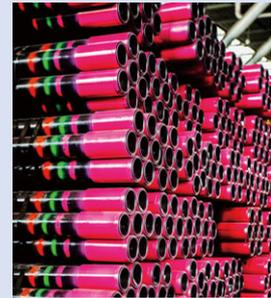
稀土素有「工業維生素」的美稱，鋼中添加微量稀土能夠顯著提高鋼的韌塑性、耐磨性、耐熱性、抗蝕性等，但是稀土元素性質活躍，生產過程添加難度極大。本集團與國內某知名大學通過產學研合作，經過近三年的共同攻關，於2022年11月實現了稀土耐腐蝕油套管在國內首發。相對於常規油套管產品，稀土耐腐蝕油套管在不增加成本的條件下，耐腐蝕性能提升50%以上，可大幅度提升油氣井的壽命，降低開採成本，提升石油工程的安全性。
