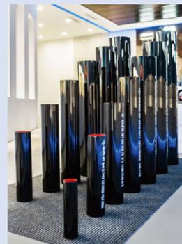
為了提升油氣鑽採的安全性，客戶對油套管的衝擊韌性要求越來越高，按照通用的API標準要求已經不能滿足需求。要滿足客戶的要求，按照傳統的工藝方法，J55、K55鋼級的油套管需採用在線常化或離線全長正火的熱處理方式生產，工序流程長、能源消耗高。為契合綠色研發的宗旨，本集團組成研發團隊，從材料的合金成分設計以及軋制過程的溫度控制和變形控制進行了大量的試驗，最終成功開發出免熱處理的高韌性J55、K55油套管產品，各項性能均達到了傳統在線常化或離線全長正火的熱處理的生產水平，與常規生產工藝相比降低25%碳排放，2022年共銷售免熱處理高韌性J55、K55油套管產品5,000餘噸。
